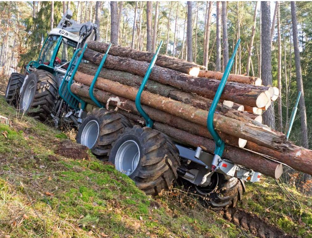
Mit bis zu 6,1 Tonnen Schubkraft unterstützt der Radnabenantrieb das Zugfahrzeug – so geht es auch an steilen Stellen immer vorwärts.
