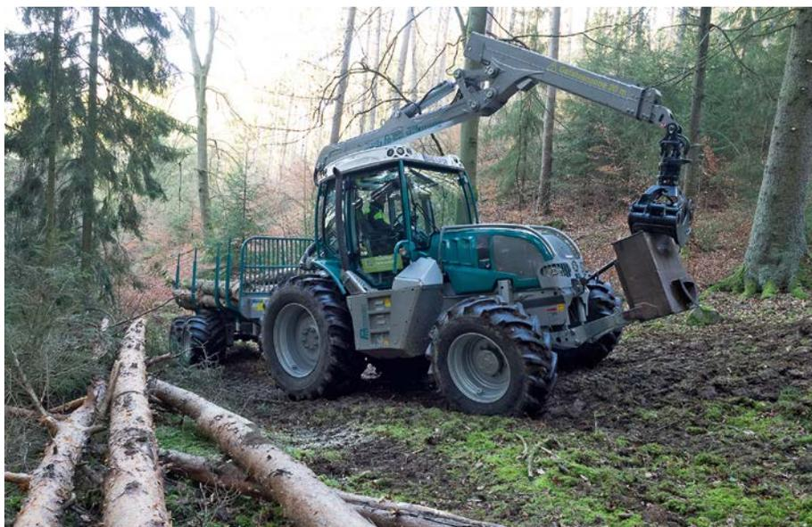
Der Pm Trac der dritten Generation wird mit angetriebenem Anhänger zum Achtrrad-System.
