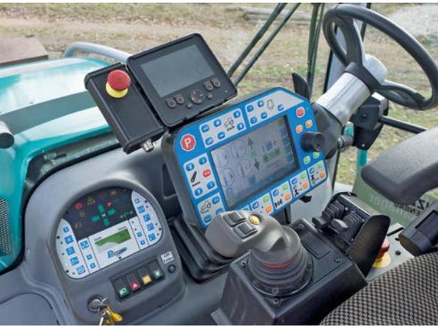
Im Arbeitseinsatz ist das Lenkrad weggeklappt. Alle anderen Bedienelemente drehen sich zusammen mit dem Sitz.
