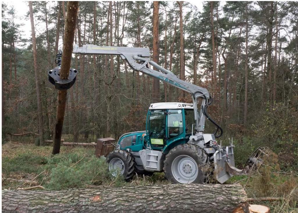
hinten untergestellt, und in weniger als fünf Minuten sind Polterschild und Klemmbank abgelegt – fertig zum Anhängen des Rückewagens. Das ist aber noch längst nicht alles: „Ich kann innerhalb einer Viertelstunde den Kran
