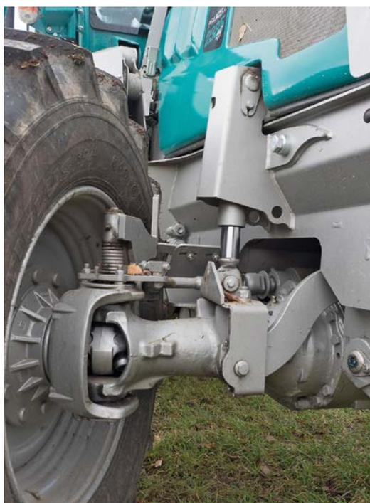
Die hydraulische Federung erlaubt eine Niveauregulierung und verblockt im Stand selbsttätig.
